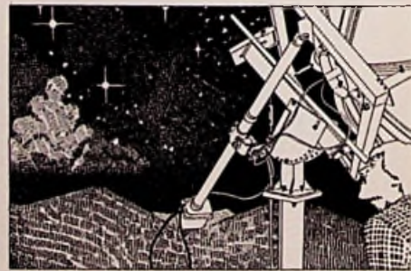
Bild 11: Die Schwenkachse wird mit einer Peilröhre nach dem Polarstern ausgerichtet
