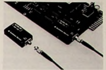
Bild 1: Optronische Send- und Empfängermodule für maximal 200 Mbit/s (ITT-Presebild)
